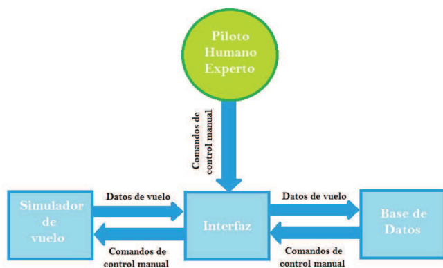
Figura 5. Diagrama a bloques que ilustra la extracción de datos del trabajo de Baomar y Bentley [5].
