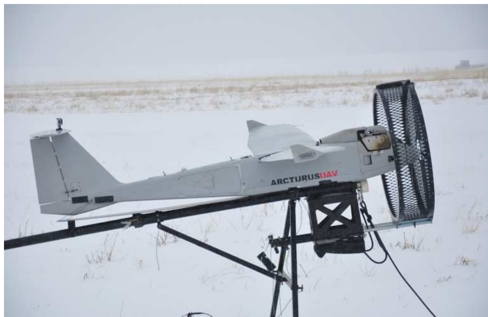
Arcturus UAV T-Series, un vehículo aéreo no tripulado de origen estadounidense con el que cuenta la armada de México.
