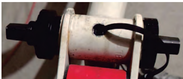
Figura 9. BB-torque Sensor 2.0 instalado en el pedalier de la bicicleta.
