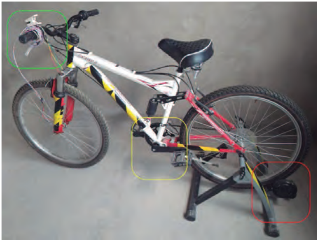
Figura 13. Bicicleta de pruebas. En cuadro verde sensor XD-58C y arnés de conexión. Cuadro amarillo sensor de torque. Cuadro rojo joy control de resistencia magnético.
