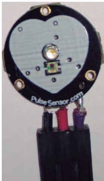
Figura 4. Sensor comercial de fotoplestismografía XD-58C, para medición del ritmo cardíaco.
