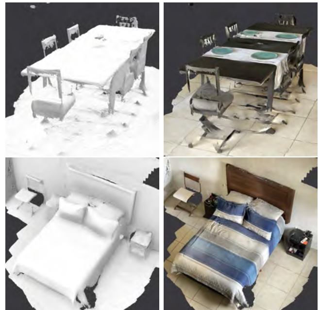
Figura 8. Planos horizontales en un hogar, reconstruidos por un robot móvil autónomo. En las imágenes superiores se observa una mesa de comedor con sus sillas y en las inferiores una recámara.
