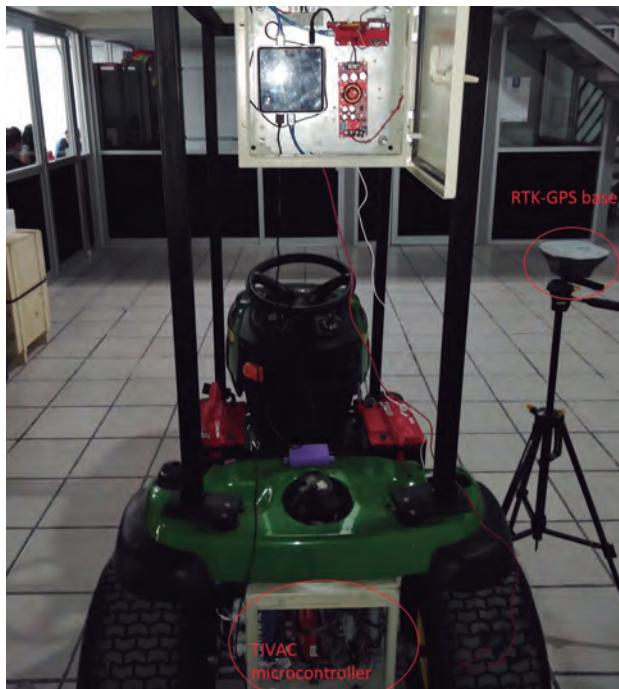
Figura 5. Instrumentación del tractor y RTK-GPS.
