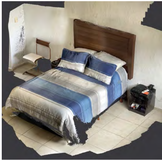
Figura 4. Una vista de la recámara reconstruida en 3D mediante el uso de los sensores RGB-D del robot.
